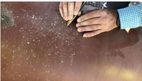
Figura 2. Testes de batida de pedras (topo) provaram que um revestimento de epóxi fusion-bonded (FBE) composto químico fornece a resistência ao impacto e à abrasão necessária para proteger a camada de base anticorrosiva FBE de ficar exposta (inferior).
