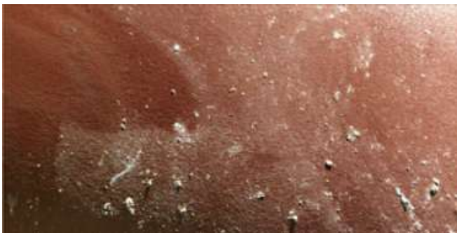
Figura 1. Las pruebas de caída de rocas en este revestimiento FBE demostraron que puede proteger la capa base FBE de impactos y rayones que podrían exponer la superficie de acero.
