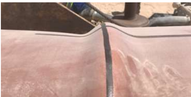
Figura 2. A pesar de doblar este tubo de muestra en un intento de romper los sistemas de revestimiento FBE aplicados, los revestimientos permanecieron intactos, demostrando su flexibilidad y resistencia al daño.
