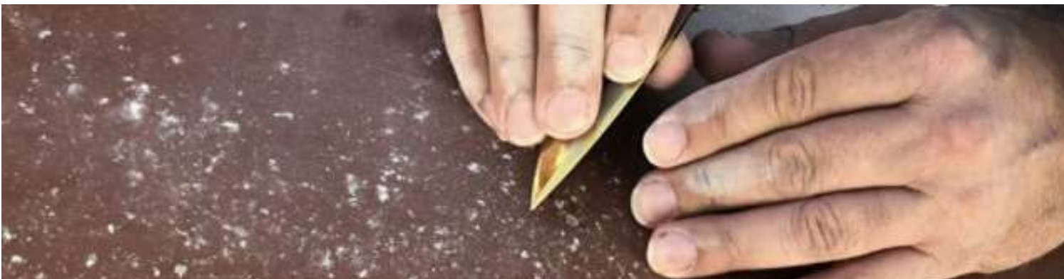
Figura 2. Apesar de flexionar este tubo de amostra na tentativa de quebrar os sistemas de revestimento FBE aplicados, os revestimentos permaneceram intactos, demonstrando sua flexibilidade e resistência a danos.
