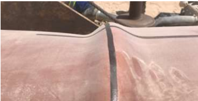
Figura 2. Apesar de flexionar este tubo de amostra na tentativa de quebrar os sistemas de revestimento FBE aplicados, os revestimentos permaneceram intactos, demonstrando sua flexibilidade e resistência a danos.
